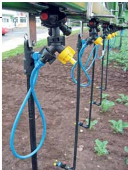
tiert bzw. montiert werden. So kann man eine Feldspritze sowohl herkömmlich als auch mit Dropleg und auch kombiniert nutzen.
